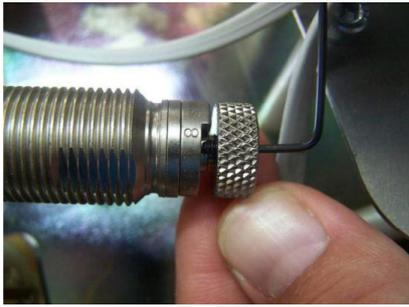
**Hinweis:** Wenn der Einstellknopf aus seiner voreingestellten Position mit sehr kleinen Bewegungen im Uhrzeigersinn gedreht wird, so erhöht sich die Bremswirkung. Umgekehrt gegen den Uhrzeigersinn verringert sich die Bremswirkung. Sobald die gewünschte Einstellung abgeschlossen ist, halten Sie den Knopf mit der einen Hand und ziehen Sie die Schraube fest an.
