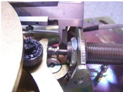
**Hinweis:** Um Schäden am Mechanismus zu vermeiden, sollte darauf geachtet werden, dass die Kolbenstange nie ganz eingedrückt wird. Sondern das immer mind. 3mm Spiel vorhanden ist. Sollte eine Lageverstellung des Dämpfers notwendig sein, so nutzen Sie immer eine Schraubensicherung (Loctite) um ein Selbstlösen der Muttern durch Vibrationen zu verhindern.
