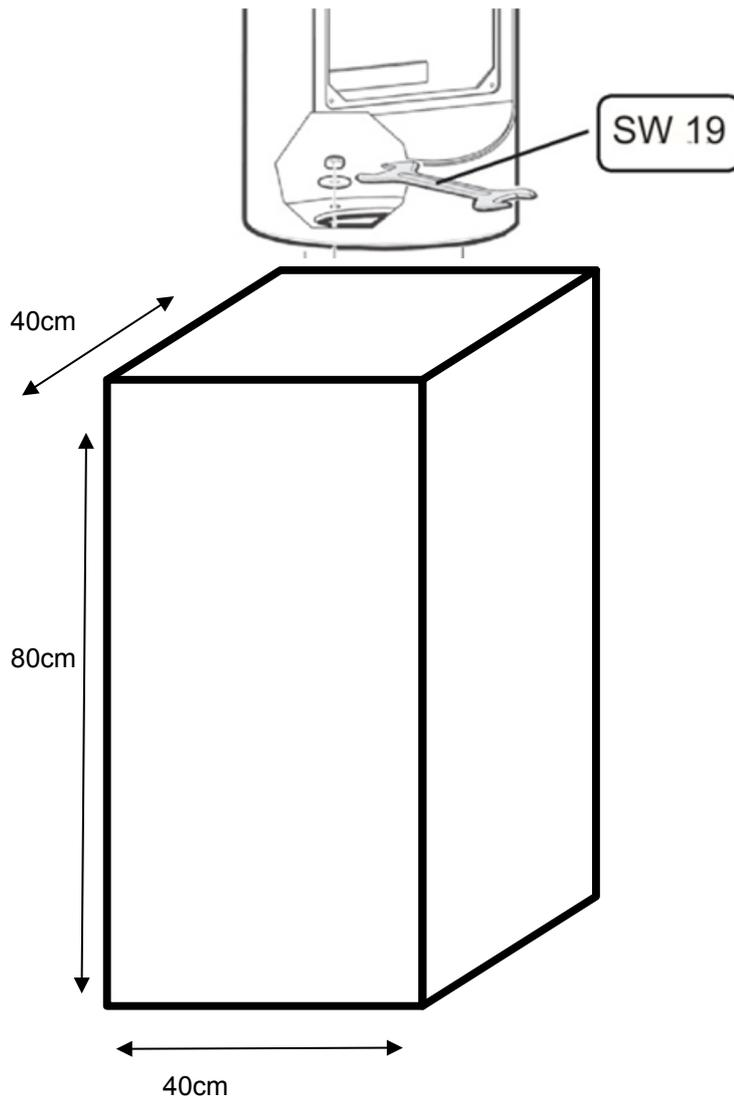
**Zuführung Leerrohr Mitte Fundament max. DN80**
