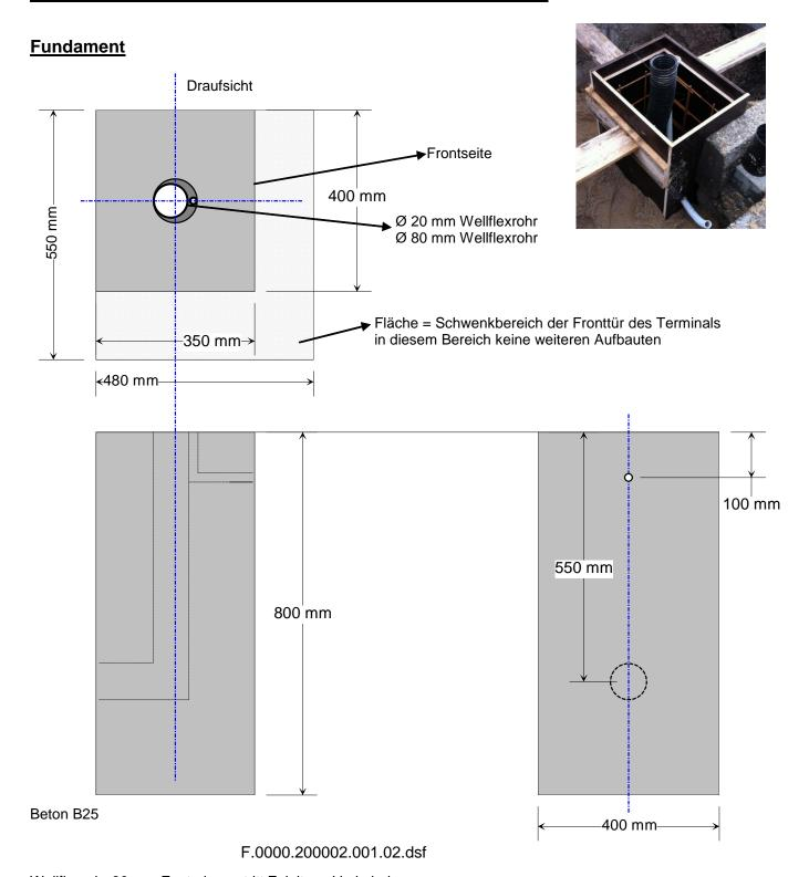
Wellflexrohr 80 mm Zentraleraustritt Zuleitung Verkabelung Wellflexrohr 20 mm Zuleitung Schleifen Fahrbahnseite
