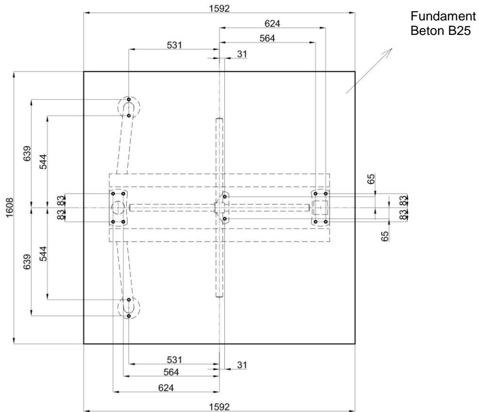
Anmerkung: Die Kabel können durch jedes der vier markierten Standrohre gelegt werden. Die Kabellänge über Grund sollte mindestens 4 Meter betragen.
